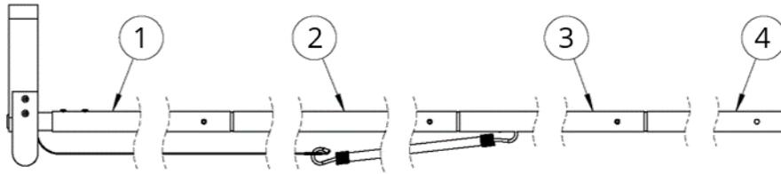
Les versions 2018 et suivantes du SnowPeeler et du SnowPeeler Premium ont été améliorées avec l'ajout d'un système de fixation élastique pour la toile. Le rôle de ce système est de réduire l'action du vent sur la toile dans des conditions venteuses et de s'assurer que la toile demeure toujours alignée avec le pôle.
